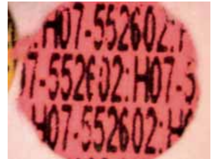
Cartucho Taser (número de referencia H07-552602), y uno de los confetti (muy ampliado) que se dispersan por el suelo tras su disparo que indica el número de serie de la carga utilizada
